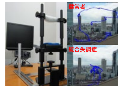
眼球運動検査のセットアップ(左)と、モニタ上に表示される写真を見ている時の視線の動き(青線、右上:健康被験者、右下:統合失調症患者)
