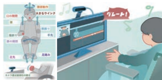
ジェスチャによる非接触型スイッチを使った環境制御装置
